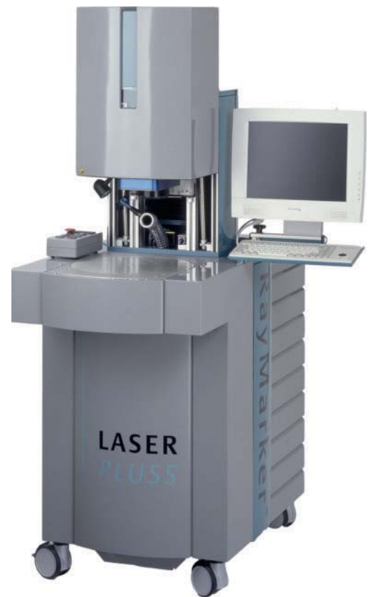
3 Ray Marker mit Drehtisch zur gleichzeitigen Laserbearbeitung und Beladung
