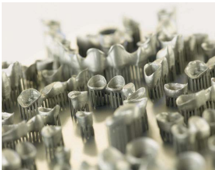
3 LaserCusing in Serienproduktion – mass customization von Kronen und Brücken (Bild: Laser Add Center)
