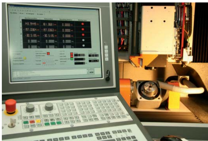
3 Die Steuerung der GL.3/5 besteht aus zwei Rechereinheiten. Die Trennung zwischen Bediensoftware und NC-Software garantiert die Echtzeitfähigkeit
