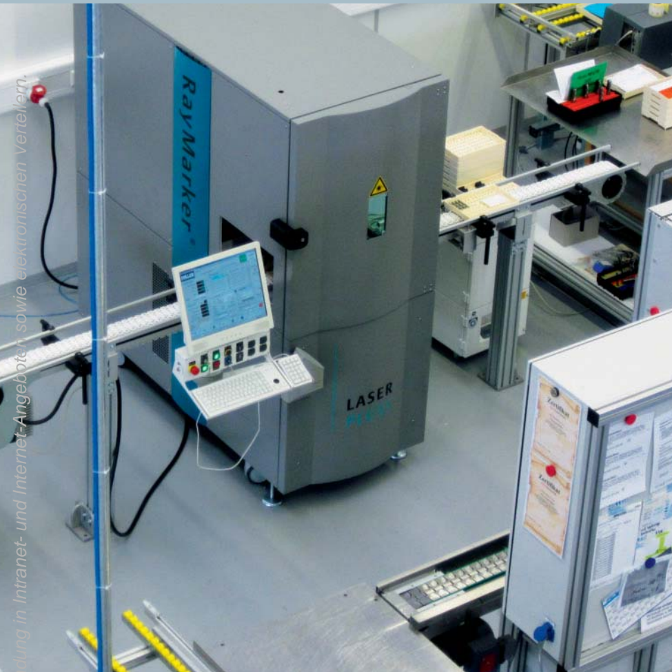
1 Verteilplatz mit integriertem RayMarker, mit Förderband zur Ein- und Ausgabe der Werkzeuge
